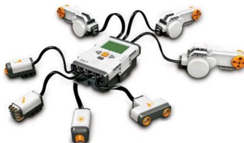
Рис. 1. Микрокомпьютер NXT с подключенными датчиками и моторами
